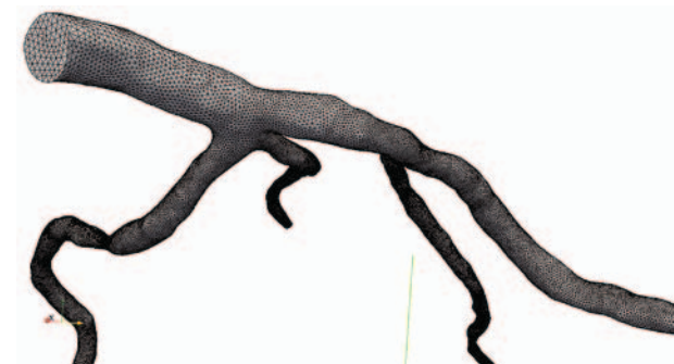
Ryc. 5. Siatka niestrukturalna lewej tętnicy wieńcowej w powiększeniu. Tworzy ją 2 758 430 czworościennych (tetragonalnych) elementów skończonych. Powstała ona na bazie wyników segmentacji badań angio-TK wykonanych w Pracowni Tomografii Komputerowej Śląskiego Centrum Chorób Serca
